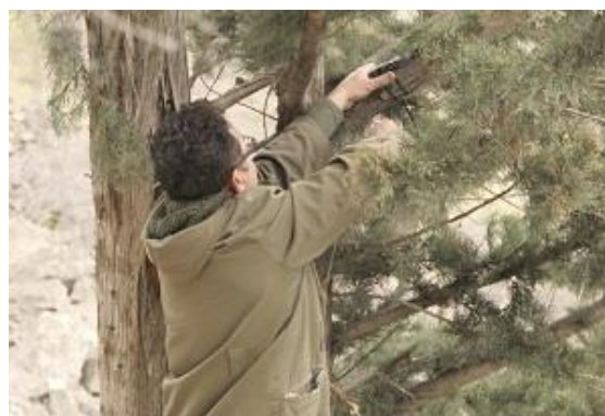
شکل ۳-۱-۶ نصب داده بردار اقلیمی دیجیتال روی شاخه زربین در رویشگاه‌های مورد مطالعه
