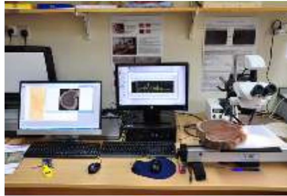
شکل ۳-۳-۳ میز کار مطالعات دندروکرونولوژی شامل دستگاه Lintab 6
