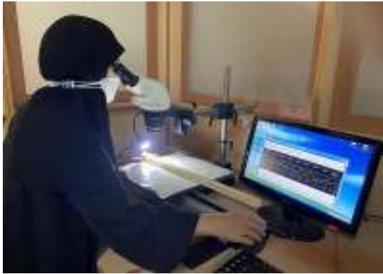
شکل ۳-۳-۳ میز کار مطالعات دندروکرونولوژی شامل دستگاه Lintab 6
