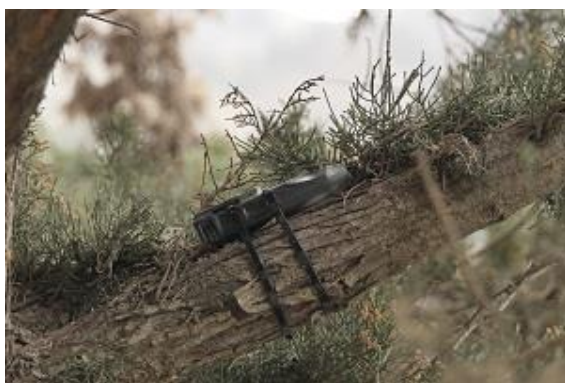
شکل ۳-۱-۶ نصب داده بردار اقلیمی دیجیتال روی شاخه زربین در رویشگاه‌های مورد مطالعه
